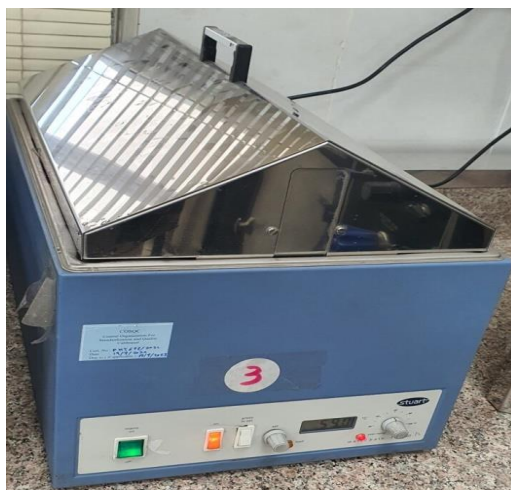
Рис. 2. Ванна для выдержки образцов цемента в воде при атмосферном давлении и температуре нагрева 60°C (140°F)
