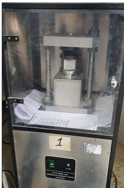
Рис. 3. Испытательной машине (OFITE Model 260) для прочности на сжатии
