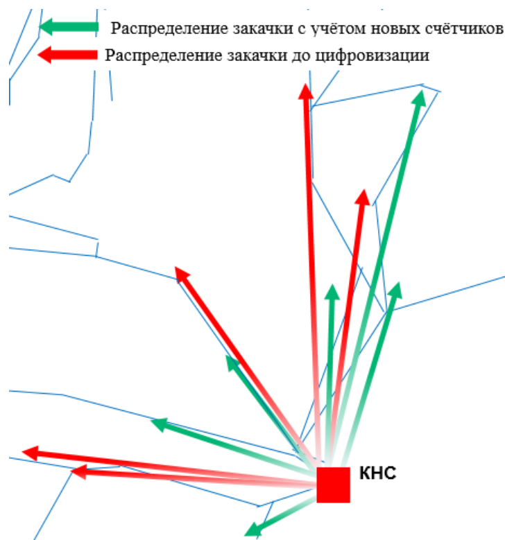
Рис. 6. Схема распределения закачиваемой воды в рамках одной КНС
