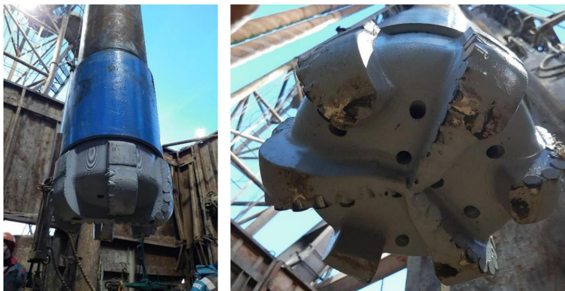
Рис. 7. Долото разбуриваемого типа, разработанное в ТатНИПИнефти совместно с ООО «Перекрыватель», диаметром 295,3 мм
