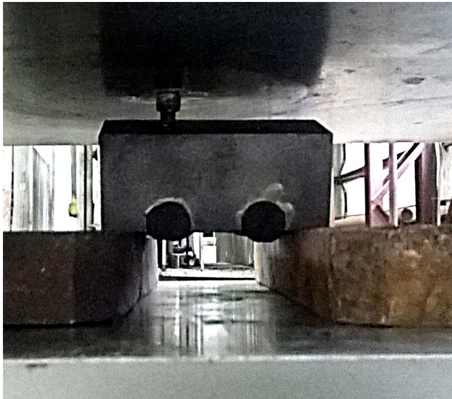
Рис. 3. Модель корпуса опытного долота с припаянными резцами PDC в процессе создания усилия прессом для вырывания резца
