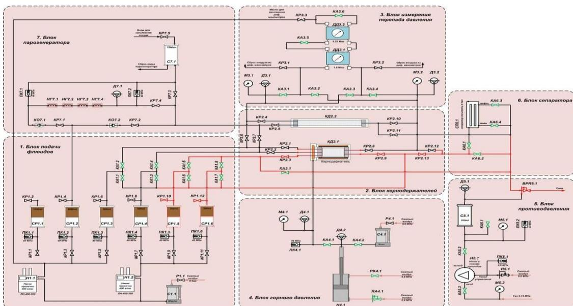
Рис. 1.2. Гидравлическая схема фильтрационной установки
