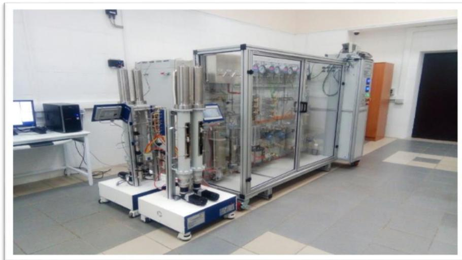
Рис. 1.1. Фильтрационная установка ПИК-ОФП/ЭП-К-Т
