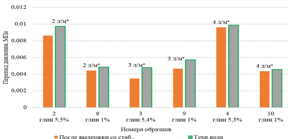
**Рис. 1.6. Сравнительный анализ перепадов давления при прокачке стабилизатора глины «Х» разных концентраций и технической воды**
