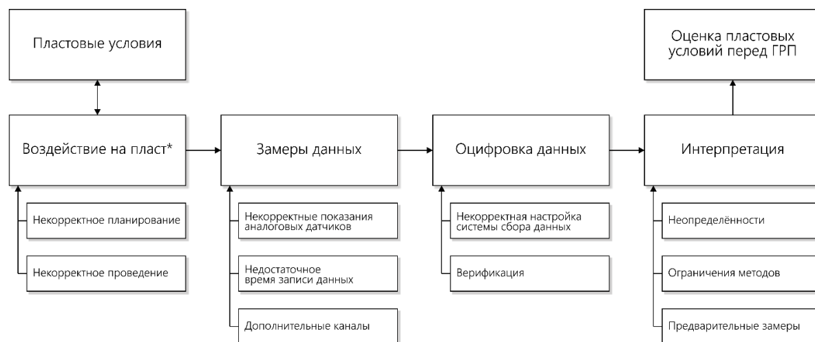
Рис. 1. Обобщённая схема передачи данных при оценке условий проведения ГРП
