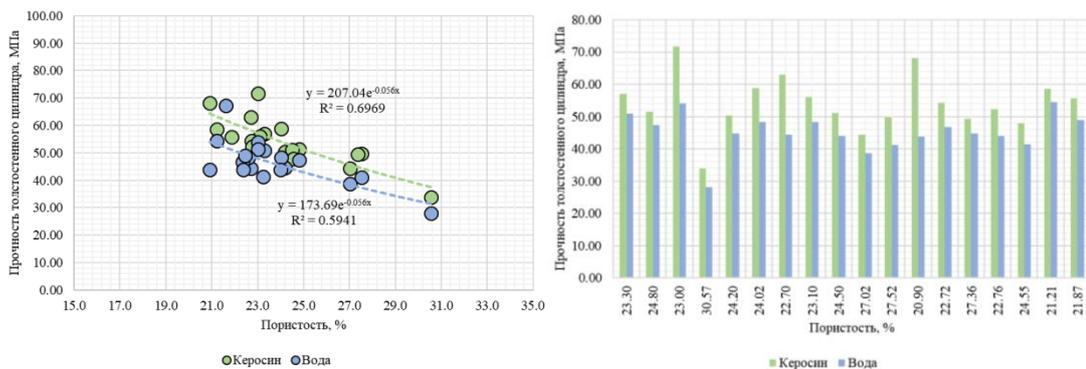
**Рис. 4. Зависимость прочности толстостенных цилиндров от пористости (слева) и гистограмма распределения прочности толстостенных цилиндров (справа) при различных флюидах насыщения**
