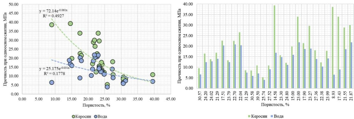
**Рис. 2. Зависимость прочности при одноосном сжатии от пористости (слева) и гистограмма распределения прочности при одноосном сжатии (справа) при различных флюидах насыщения**
