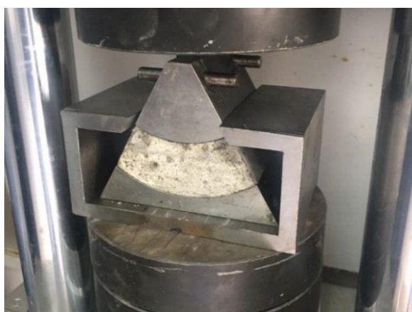
Рис. 4. Испытание сегмента цементного полукольца на сжатие
